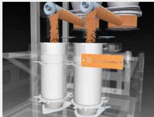
Virtuální 3D model dávkovacího zařízení ke kalibracím DEM (Discrete Element Method) a optimalizacím fyzického zařízení.
